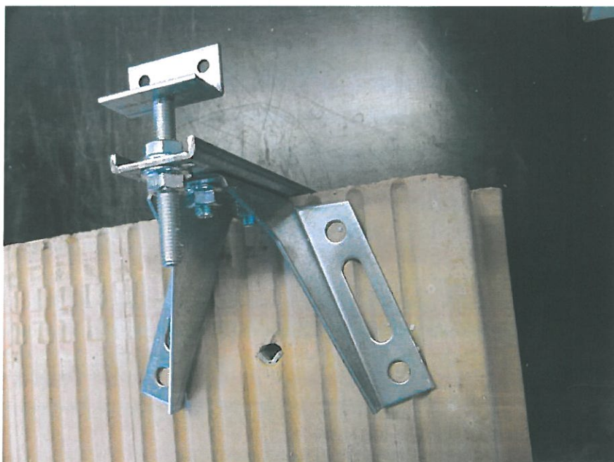
Bild 4 Befestigungssystem 3 (Variante 1), im Ziegelstein montiert
