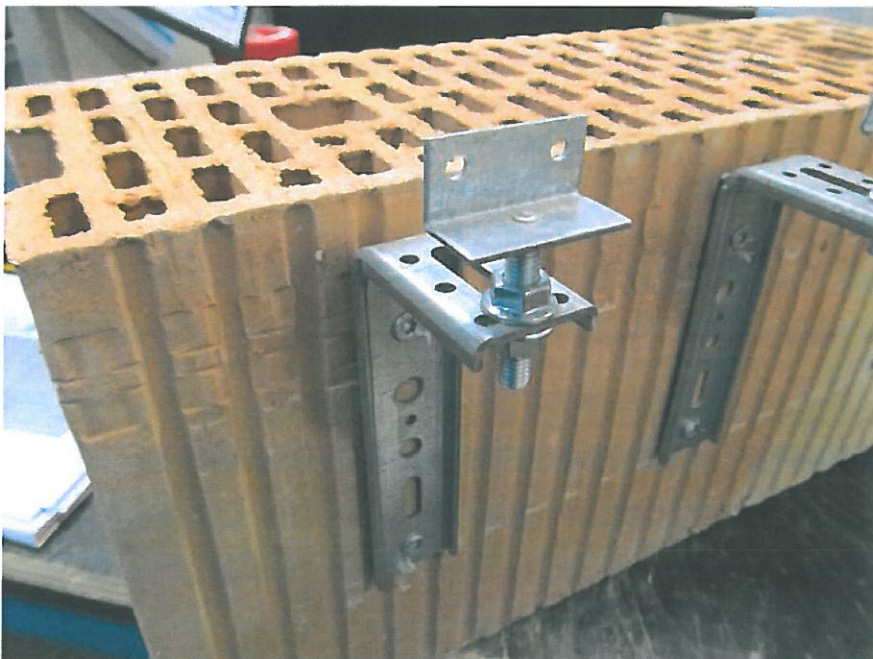
Bild 6 Befestigungssystem 4, im Ziegelstein montiert
