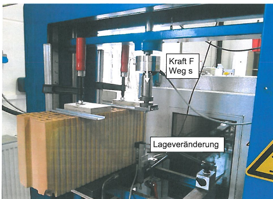
Bild 9 Prüfaufbau Belastung in Fensterebene
