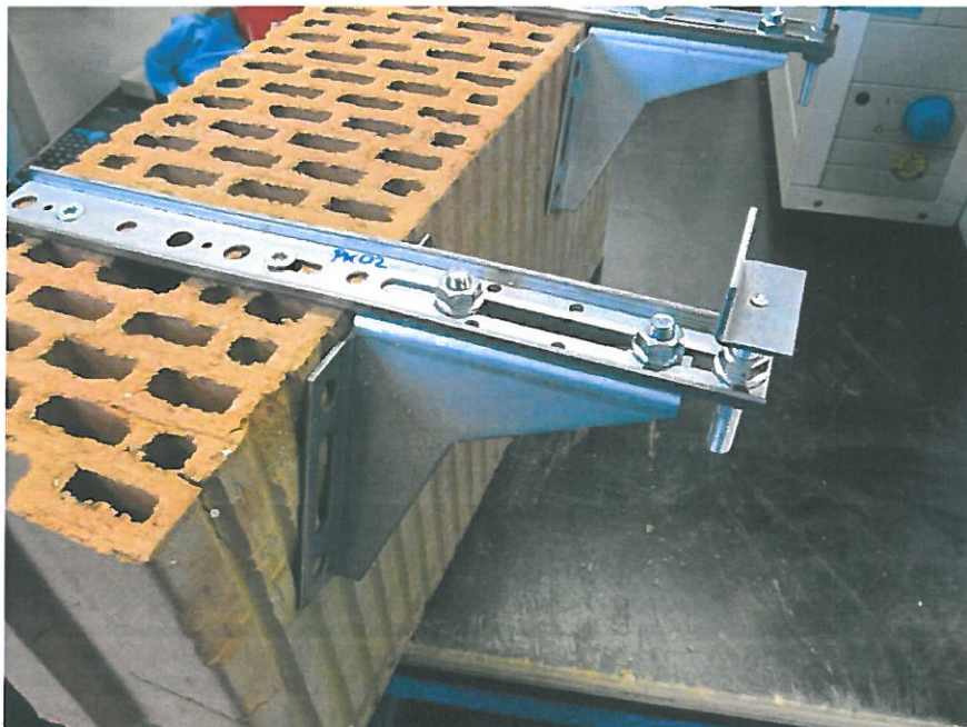
Bild 5 Befestigungssystem 3 (Variante 2), im Ziegelstein montiert
