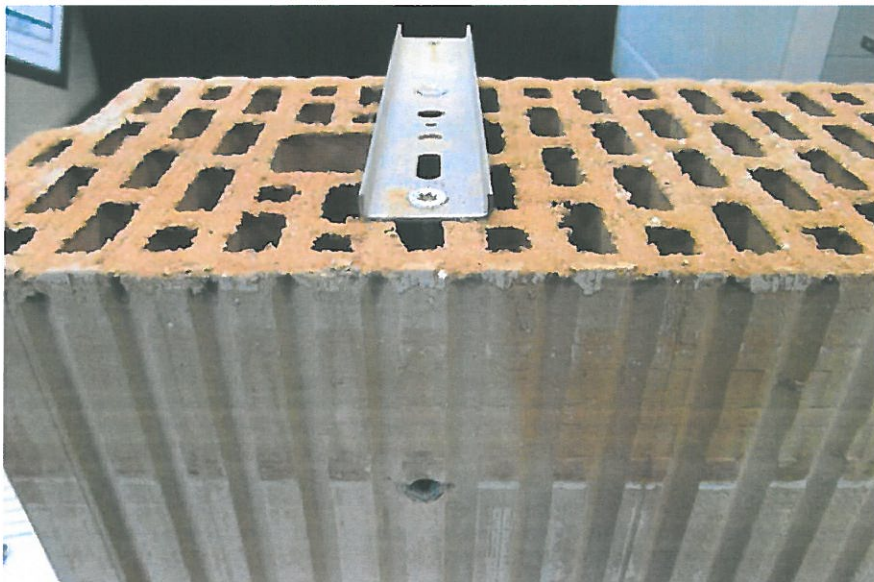
Bild 1 Befestigungssystem 1, im Ziegelstein montiert
