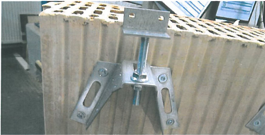
Bild 7 Befestigungssystem 5, im Ziegelstein montiert
