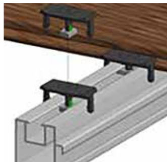
Befestigung auf Alu- Unterkonstruktion
