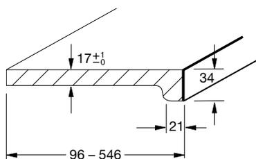
WERZALIT Systemfensterbänke mit drei Blendenhöhen für Sanierung und Objektausbau. Alle Systemfensterbänke sind mit Ziernut versehen, die auf Wunsch auch als farbliche Akzentuierung ohne Preisaufschlag in allen RAL-Tönen erhältlich ist.
